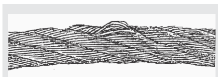
Fig. 6: cabo de aço com indício de desgaste e rotura nos fios.
