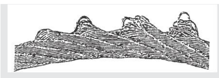
Fig. 7: cabo de aço danificado: nunca utilizar um cabo de aço nestas condições.
